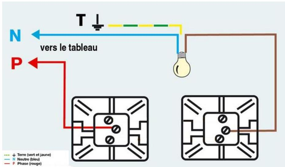
b-) Dans une installation électrique, quelle est la couleur du fil de terre ?
